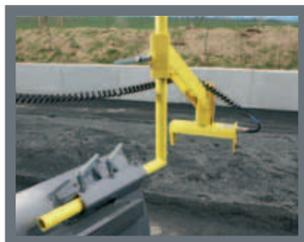
de medición de 250 mm. Esta gran anchura hace posible guiar al Sonic-Ski® fácilmente especialmente sobre una cable. El software especial mantiene automáticamente la cuchilla sobre la referencia. Para un fácil posicionamiento, los valores objetivo de la unidad de control también pueden ser ingresados directamente en el sensor con botones en el mismo.
