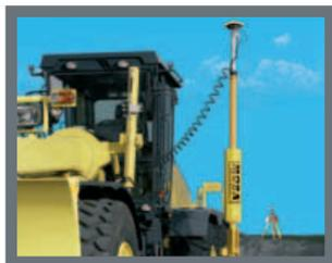
obra. La información de cotas se procesa con la ayuda de un programa informático especial y con una estación total robotizada o un GNSS. Este sistema determina continuamente la posición de la
